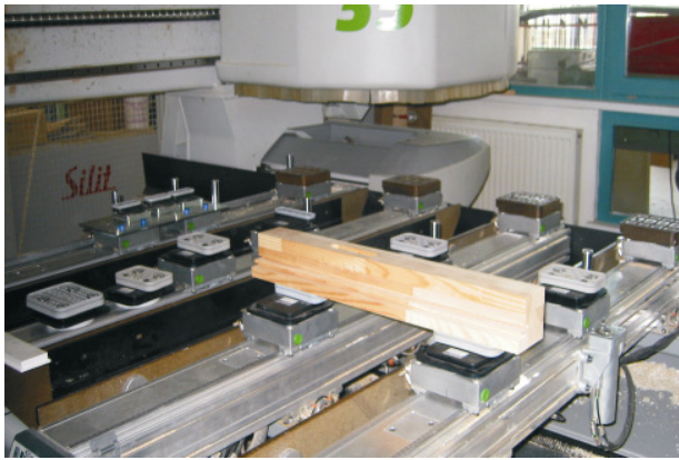
Biesse製コンソールに対応した真空クランプブロックVCBL-B
