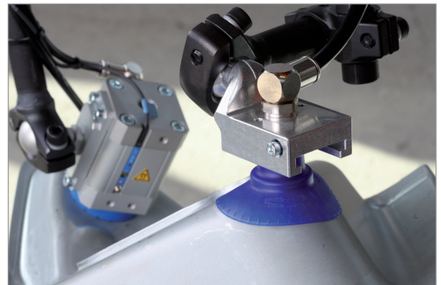
成形された金属部品の凸部分を吸着するSAXM/パッド
