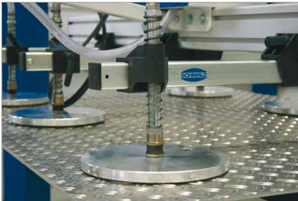
真空パッド SPKによる縞鋼板の搬送
