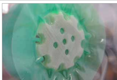
フィルムの変形と、パッド内部への引込みを抑制
